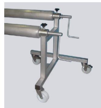
**Éclipse double axe** : 2 supports soudés en inox munis chacun de 3 roues multidirectionnelles dont 2 avec frein. 2 axes en inox de Ø 140 mm. Manivelles de manœuvre et molettes de frein.
