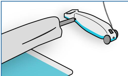
**7.** A la fin de l'enroulement retirez RollPower en pressant légèrement sur la touche REVERSE située à l'arrière de l'appareil afin de désengager le carré d'enroulement plus facilement.
